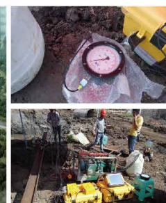
江西萍乡金融中心 桩径2.4米 极限承载力7900吨
