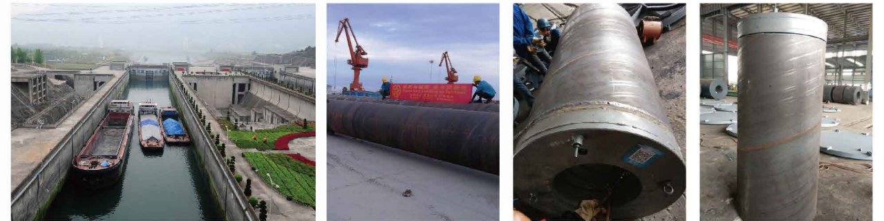
江苏扬州万福船闸 桩径1.2米 极限承载力3000吨
